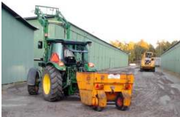
Lastmaskinen lägger ut stenmjöl och traktorn saltar.
