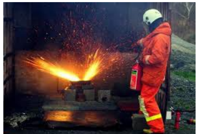
Många battericeller brinner explosionsartat med långa jetstrålar. Bilden visar brand i litiumceller.
