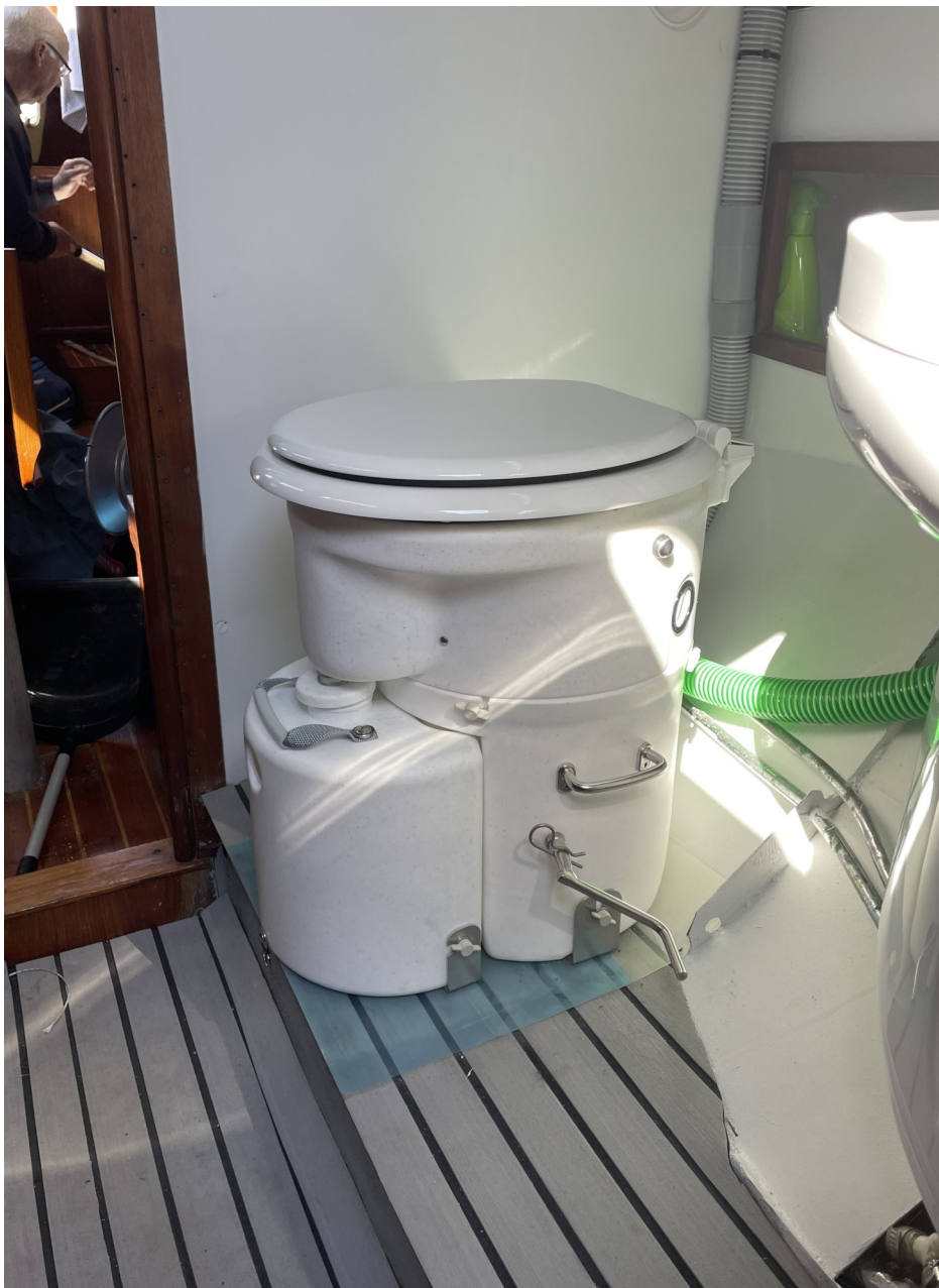
Den grå slangen är ventilation, den gröna är sötvattenslangen till köket.
